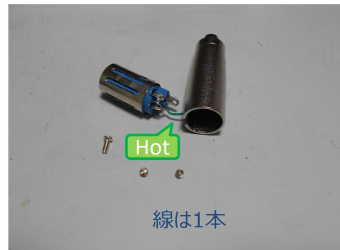
組立式ボディの導通を頼りとしたGND側の接触不良が信号断・ノイズ混入(GND浮き)の原因と推定
