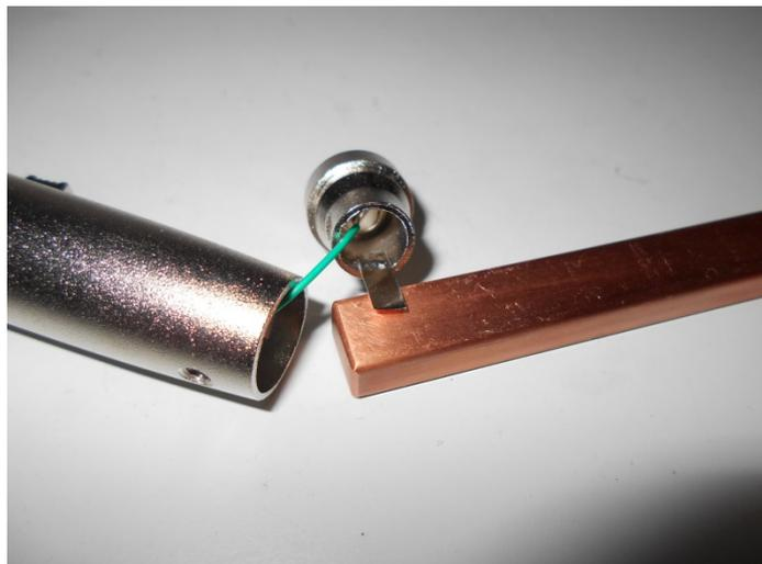
スポット溶接したGND側タブへ電線を半田付
