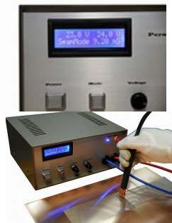
シームモードでローラー電極を使用メッシュを溶接
